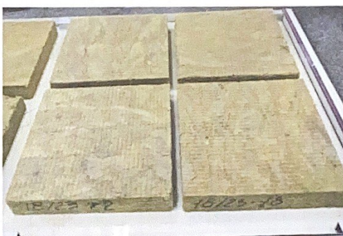
Рисунок 11 – Зволоження дослідних зразків № 18/23 теплоізоляційного матеріалу марки «ТЕХНОФАС ДЕКОР»
