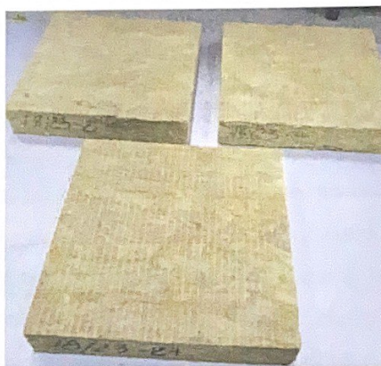
Рисунок 1 – Зразки № 18/23 теплоізоляційного матеріалу марки «ТЕХНОФАС ДЕКОР» Загальний вигляд випробувальної установки наведено на рис. 2.
