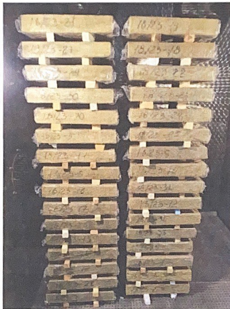
Рисунок 4 – Дослідні зразки, які піддають циклічному температурному впливу
