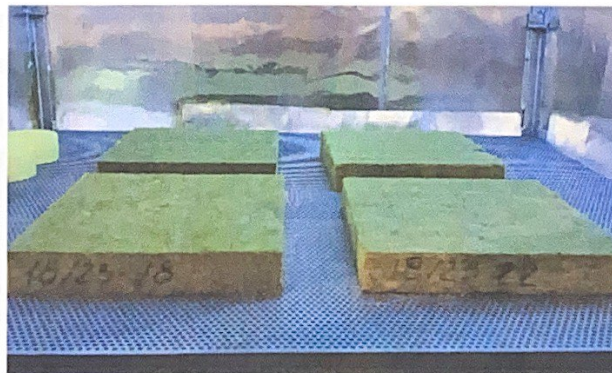
Рисунок 10 – Загальний вигляд дослідних зразків № 18/23 теплоізоляційного матеріалу марки «ТЕХНОФАС ДЕКОР» під час опромінення
