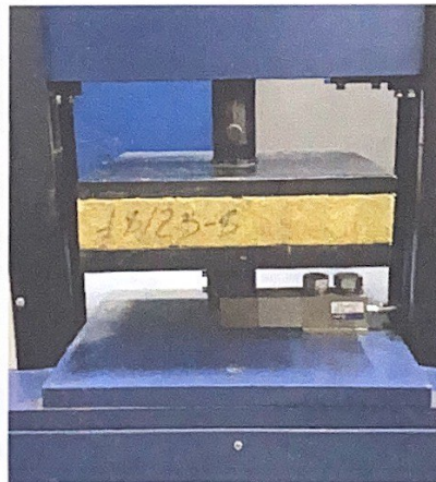
Рисунок 6 – Проведення випробування міцності на стиск при 10% деформації зразків № 18/23 теплоізоляційного матеріалу марки «ТЕХНОФАС ДЕКОР»
