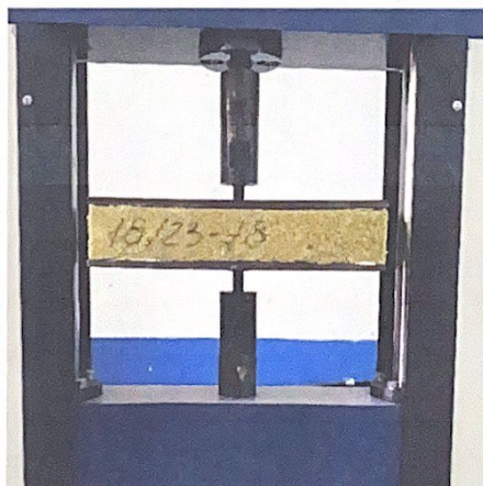
Рисунок 8 – Проведення випробування міцності при розтягу у напрямку, перпендикулярному до площини виробу зразків № 18/23 теплоізоляційного матеріалу марки «ТЕХНОФАС ДЕКОР»
